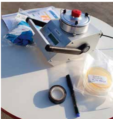
Obrázek 3: Měřicí přístroj pro izokinetický odběr částečného toku s destičkami živých médií (3 kusy v sadě) (Messgerät zur isokinetischen Teilstromentnahme mit Nährmedienplatten (3 Stück im Set))
