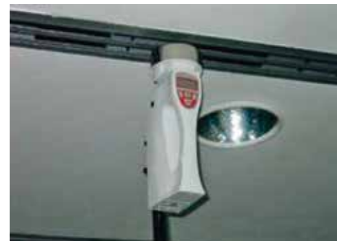
Obrázek 2: Měřicí přístroj pro stanovení počtu zárodků ve vzduchu (Messgerät zur Luft-Keimzahlbestimmung) [2].
