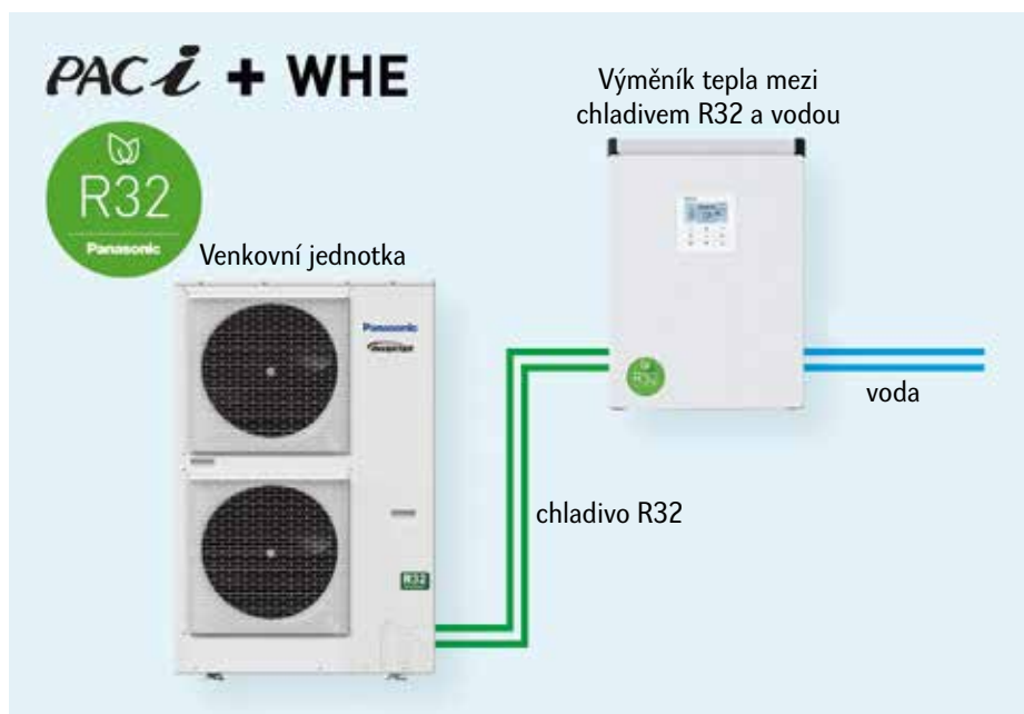
Nový výměník tepla pro řadu komerčních jednotek Panasonic PACi s chladivem R32 v klimatizačních systémech pro chlazení nebo ohřev vody Foto Panasonic
