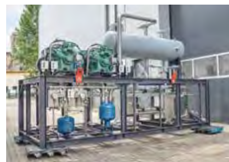
Bloková čpavková chladicí jednotka (Ammoniak Kaltwassersatz) od firmy compact Kältetechnik s rekuperací tepla s chladicím výkonem 175 kW a s elektroinstalací z výrobního závodu (Vorverdrahtung) při dodání (im Auslieferungszustand)
