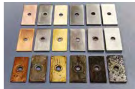
Kovové destičky jako zkušební vzorky. Korozní test podle normy ASTM D1384: Kovové vzorky před korozním testem (naoře), po testu s vysoce kvalitním výrobkem Tyfocor (uprostřed) a po testu s horším konkurenčním výrobkem (dole).
