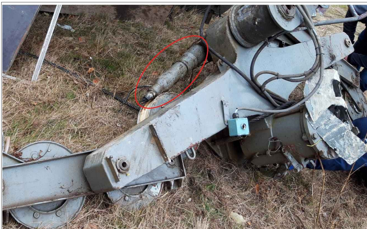
Obr. č. 2: Běhoun vozu č. 2 se zvýrazněným pouzdrům koncovky tažného lana
